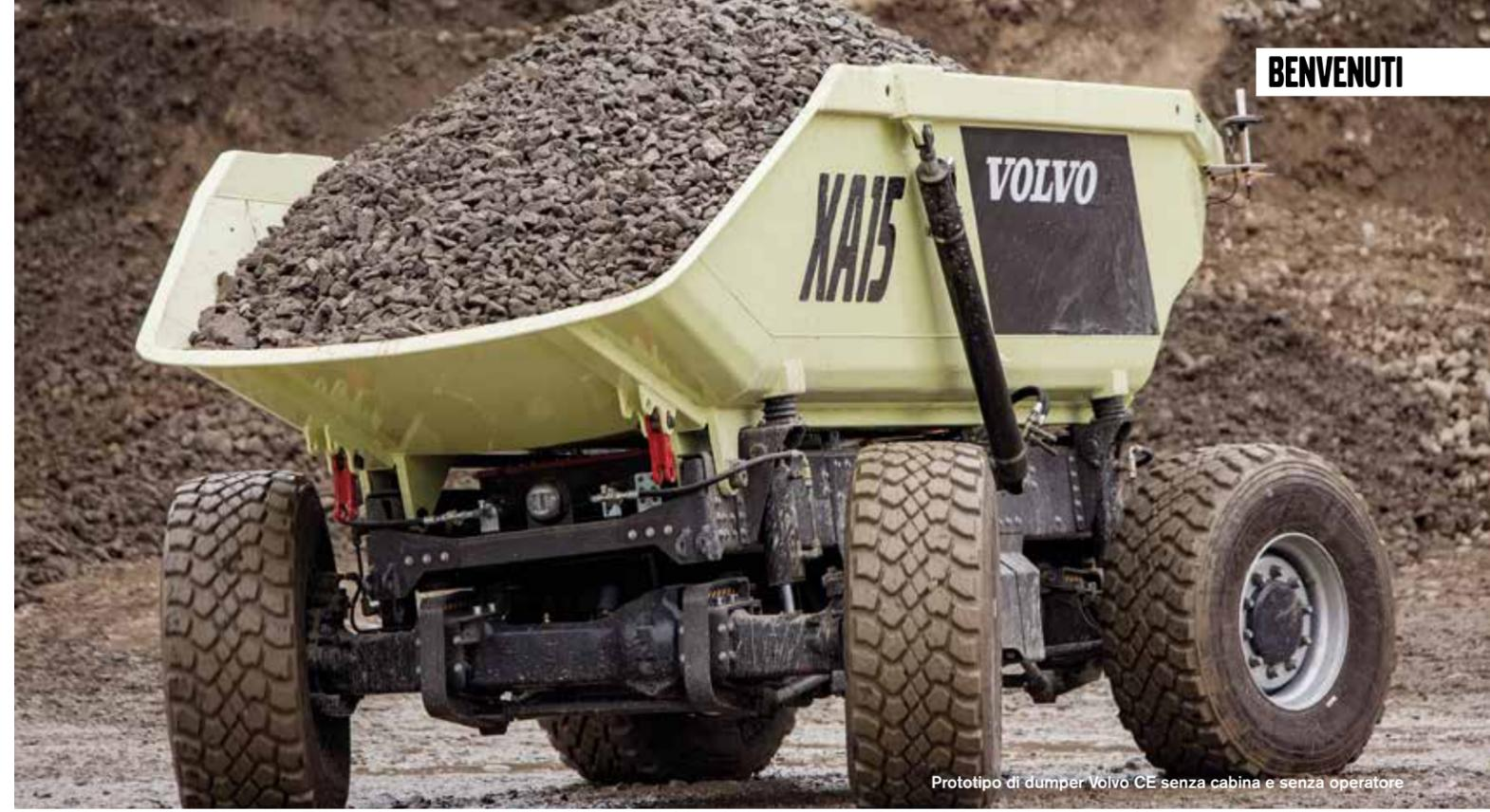
Prototipo di dumper Volvo CE senza cabina e senza operatore
