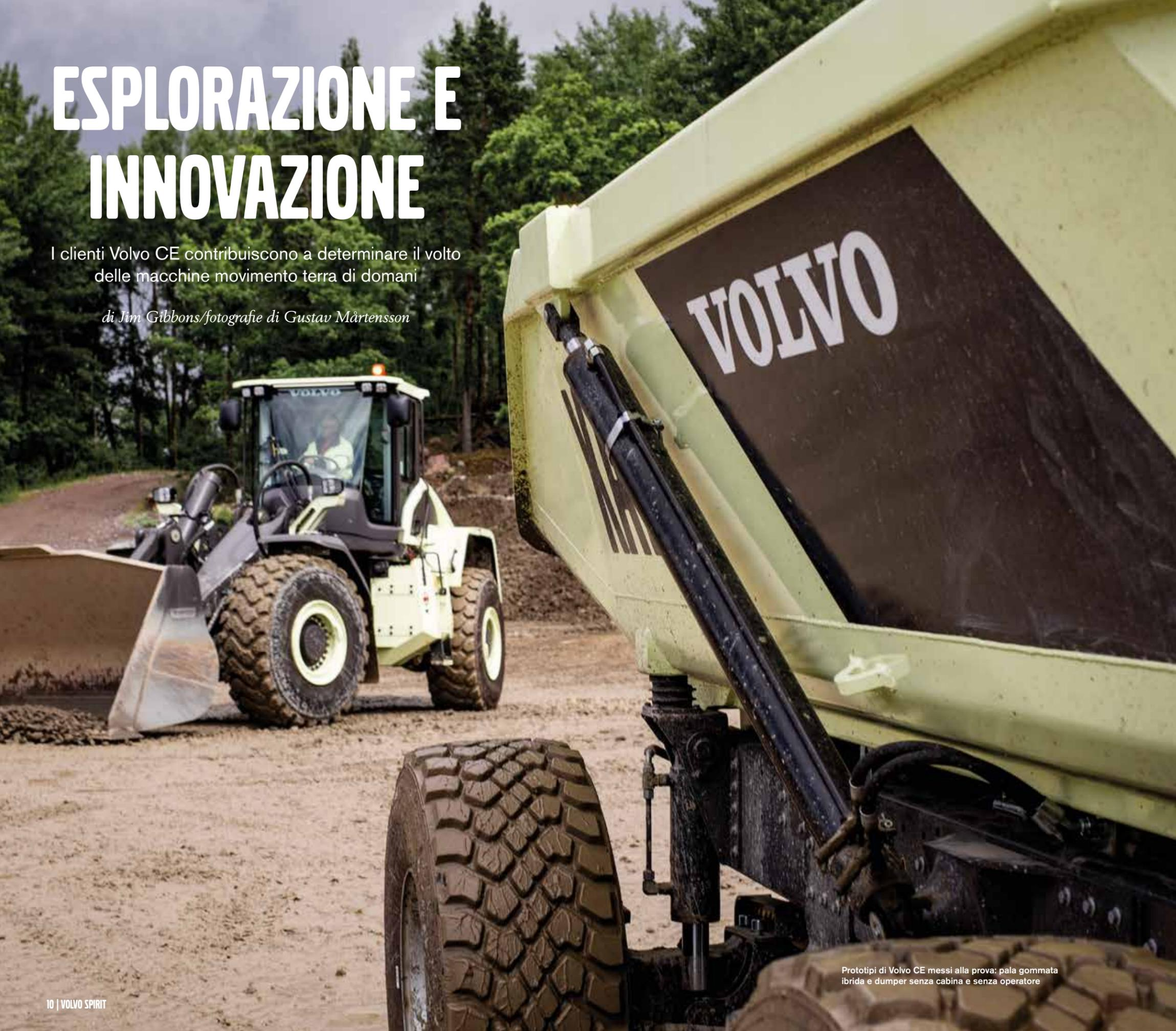
Prototipi di Volvo CE messi alla prova: pala gommata ibrida e dumper senza cabina e senza operatore
