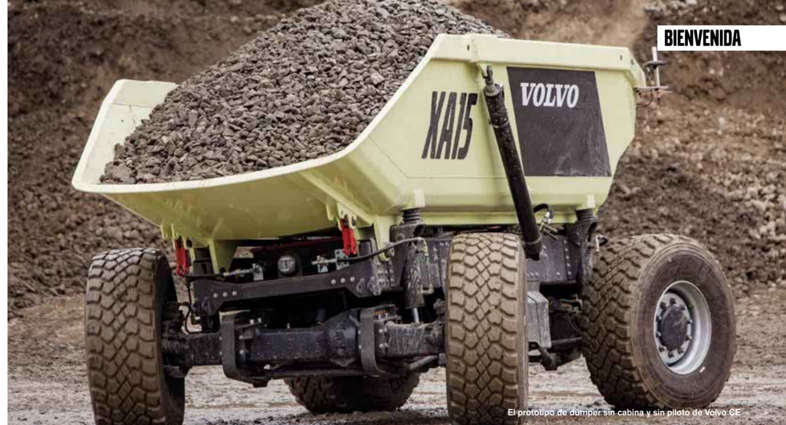
El prototipo de dumper sin cabina y sin piloto de Volvo CE
