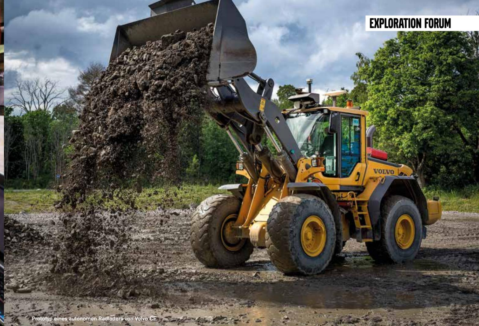
Prototyp eines autonomen Radladers von Volvo CE
