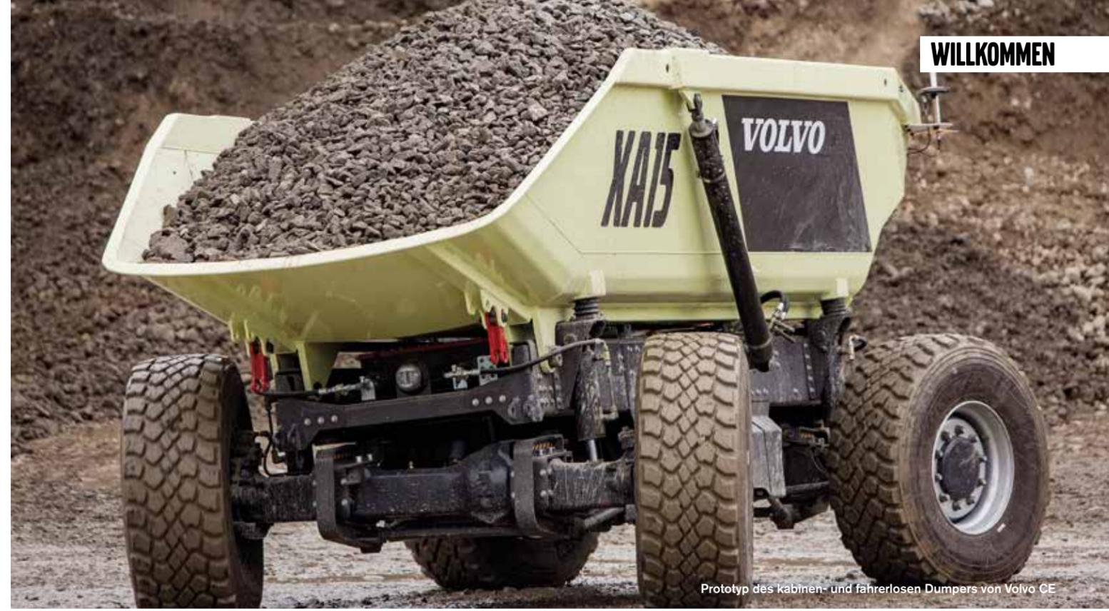
Prototyp des kabinen- und fahrerlosen Dumpers von Volvo CE
