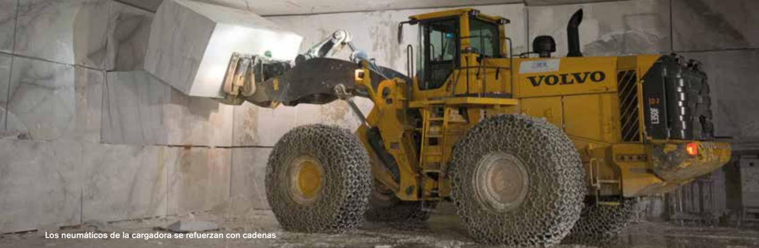
Los neumáticos de la cargadora se refuerzan con cadenas
