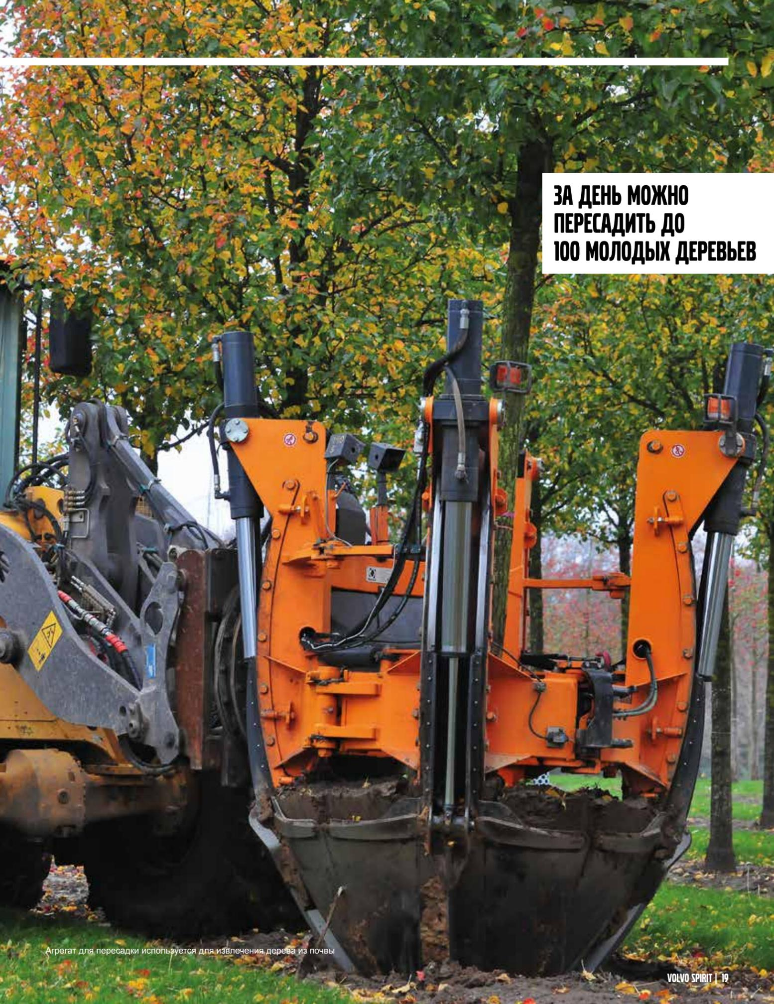
Агрегат для пересадки используется для извлечения дерева из почвы
