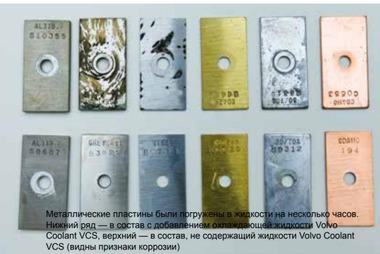
Металлические пластины были погружены в жидкости на несколько часов. Нижний ряд — в состав с добавлением охлаждающей жидкости Volvo Coolant VCS, верхний — в состав, не содержащий жидкости Volvo Coolant VCS (видны признаки коррозии)
