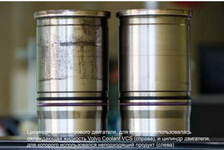
Цилиндр шестилитрового двигателя, для которого использовалась охлаждающая жидкость Volvo Coolant VCS (справа), и цилиндр двигателя, для которого использовался неподходящий продукт (слева)
