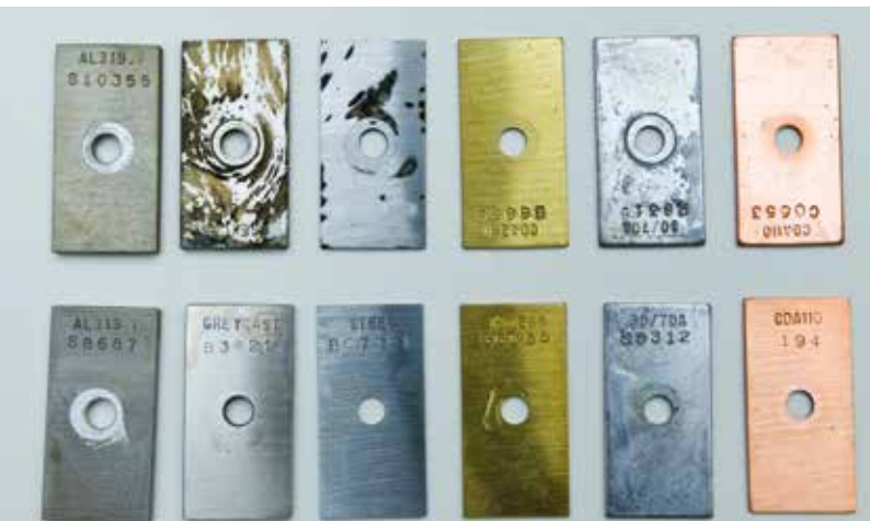
Metalen die een aantal uren in vloeistof gedompeld zijn: onderste rij - Volvo VCS koelvloeistof - bovenste rij: zonder Volvo VCS koelvloeistof verschijnt er corrosie
