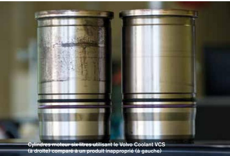
Cylindres moteur six litres utilisant le Volvo Coolant VCS (à droite) comparé à un produit inapproprié (à gauche)
