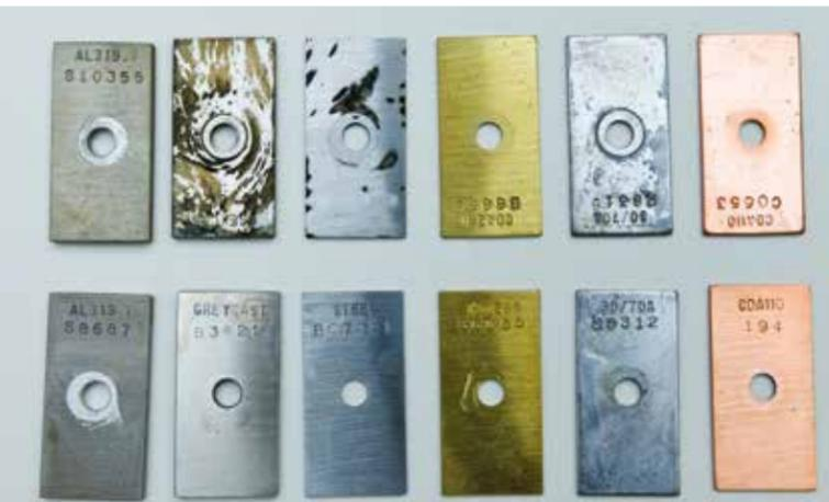
Métaux immergés dans le liquide photographié après quelques heures : rangée de dessous, avec Volvo Coolant VCS ; rangée de dessus, sans Volvo Coolant VCS
