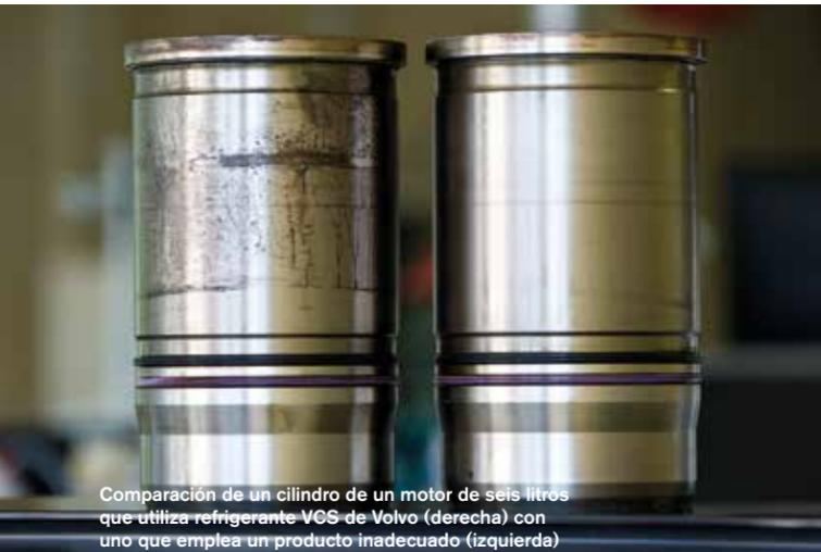
Comparación de un cilindro de un motor de seis litros que utiliza refrigerante VCS de Volvo (derecha) con uno que emplea un producto inadecuado (izquierda)
