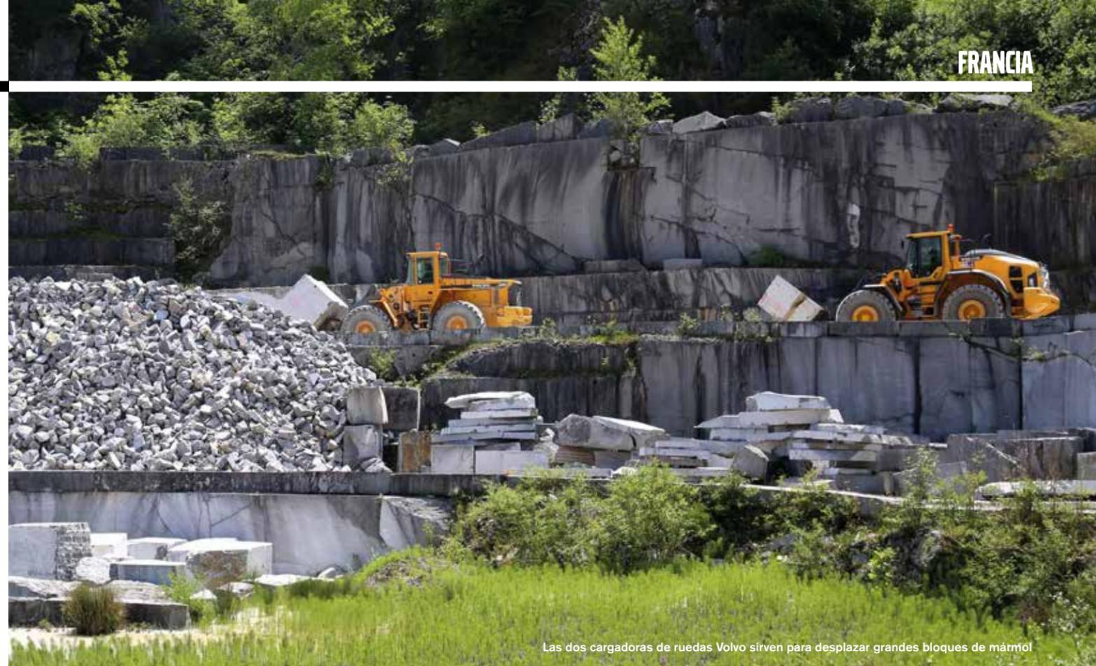
Las dos cargadoras de ruedas Volvo sirven para desplazar grandes bloques de mármol
