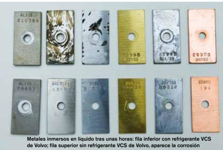
Metales inmersos en líquido tras unas horas: fila inferior con refrigerante VCS de Volvo; fila superior sin refrigerante VCS de Volvo, aparece la corrosión
