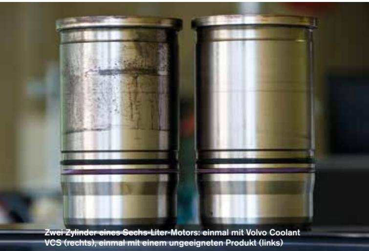
Zwei Zylinder eines Sechsliter-Motors: einmal mit Volvo Coolant VCS (rechts), einmal mit einem ungeeigneten Produkt (links)
