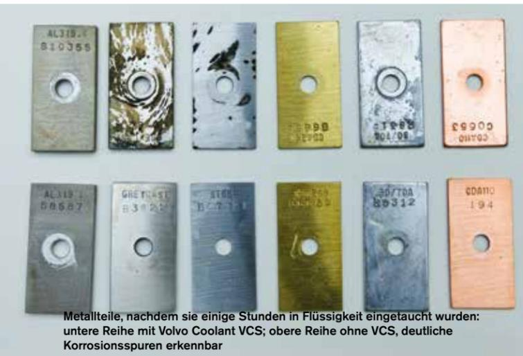
Metallteile, nachdem sie einige Stunden in Flüssigkeit eingetaucht wurden: untere Reihe mit Volvo Coolant VCS; obere Reihe ohne VCS, deutliche Korrosionsspuren erkennbar
