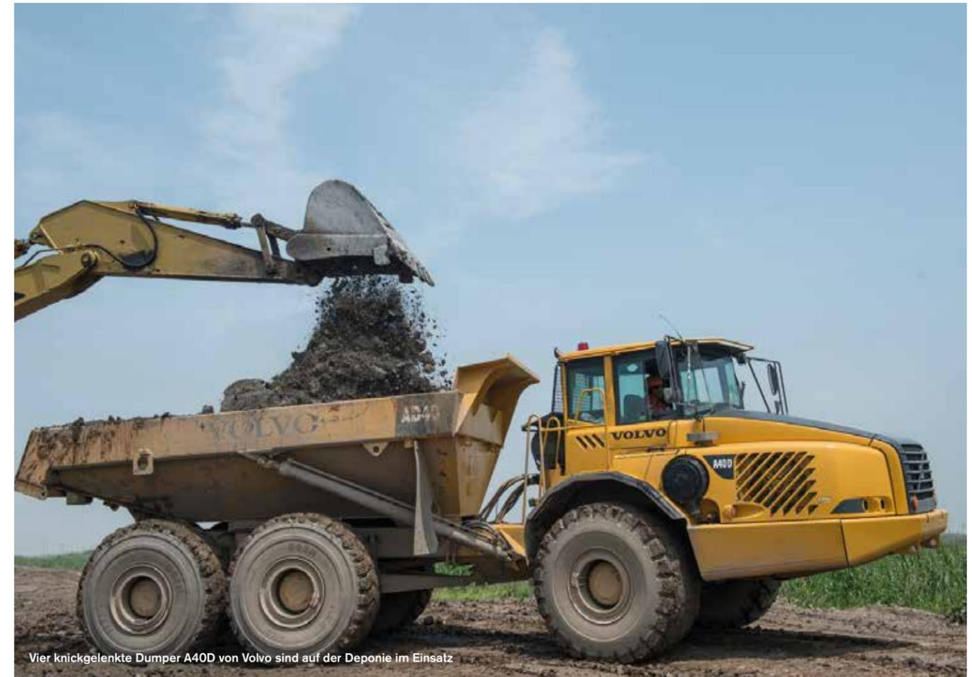
Vier knickgelenkte Dumper A40D von Volvo sind auf der Deponie im Einsatz
