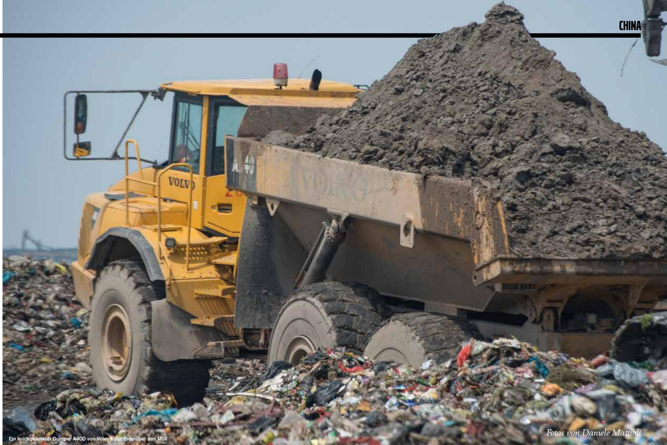
Ein knickgelenkter Dumper A40D von Volvo kippt Erde über den Müll
