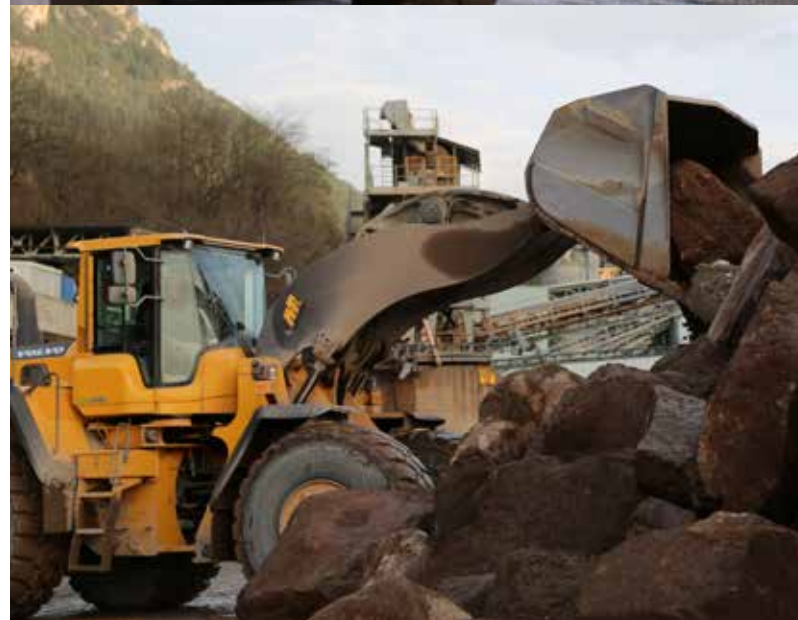
Ładowarka kołowa Volvo L250G ma większą łyżkę w porównaniu z poprzednimi modelami
