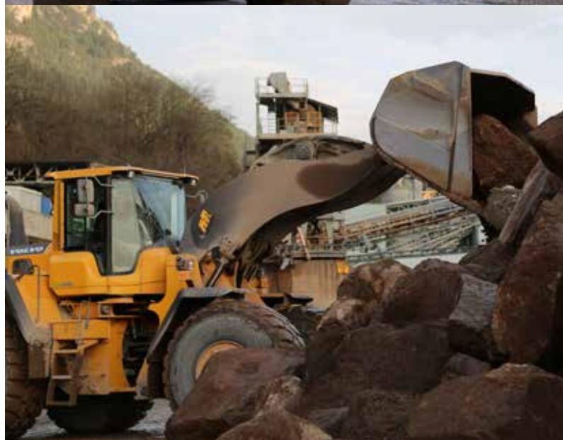
De Volvo L250G wiellader heeft een grotere laadbak dan zijn voorgangers
