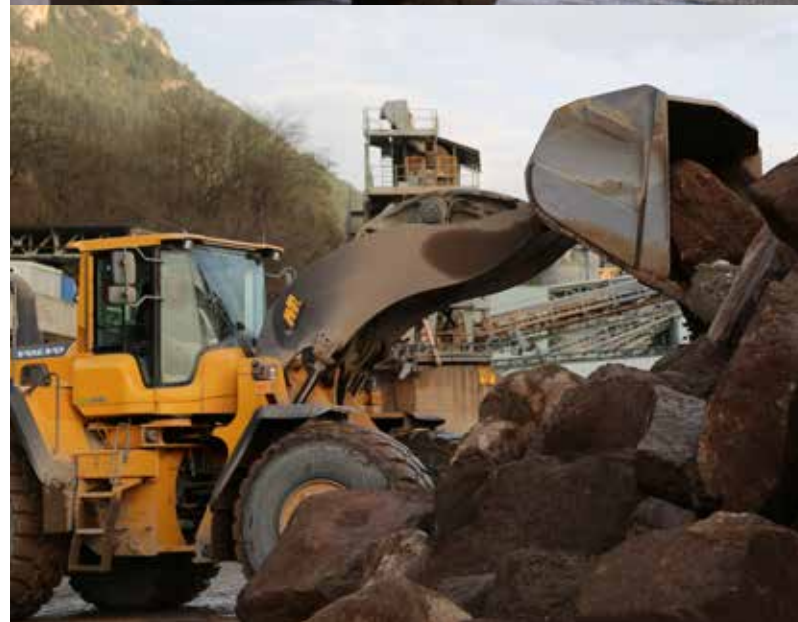
Wheel loader L250G Volvo memiliki ukuran bucket yang lebih besar dibandingkan model sebelumnya
