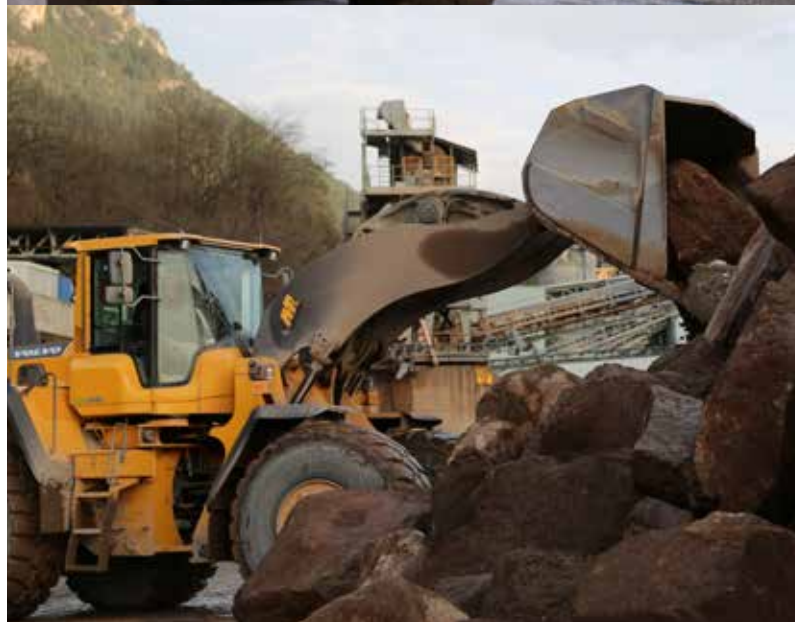
La cargadora de ruedas L250G tiene una cuchara más grande que las máquinas anteriores
