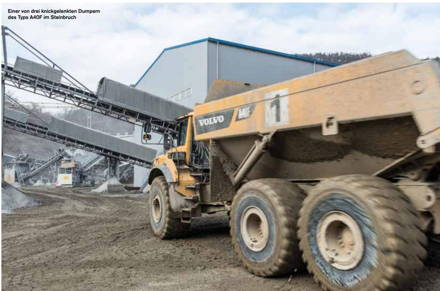
Einer von drei knickgelenkten Dumpfern des Typs A40F im Steinbruch
