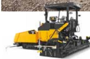
Der ABG Straßenfertiger P8720B von Volvo Construction Equipment ermöglicht einen besonders produktiven, präzisen Einbau im hart umkämpften Markt. Dieser Fertiger mit Doppelstamperbohle ermöglicht einen Einbau mit einer Belagstärke von rekordverdächtigen 400 mm in einer Breite von bis zu 9 m und eine besonders effektive Vorverdichtung. Der P8720B wurde für Arbeiten auf zementgebundenen Tragschichten entwickelt. Er sorgt für besonders hohe Dichte und kontinuierliche Einbauarbeiten.
