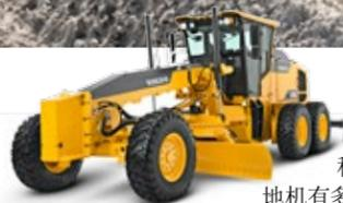
沃尔沃建筑设备公司生产的G946C自行式平地机为您提供精准的控制性能，适用于任何施工场合，从精细平地、土方作业到扫除积雪，都能轻松胜任。配备沃尔沃独有的11速变速箱，此款自行式平地机有多档速度可调，使您自如应对所有的平地任务。G946C专为实现最佳性能和最高生产力而打造，即使在最严苛的作业环境下，也是一个稳定的重型平地平台。
