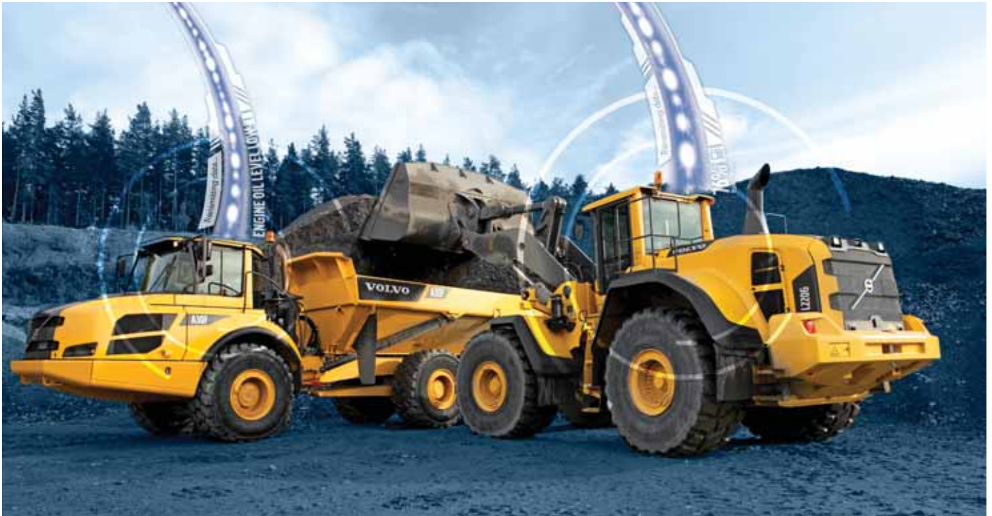
CareTrack 系统可以将包括油耗和运行性能在内的各种机器资料远程传送给机器所有者和当地经销商。
