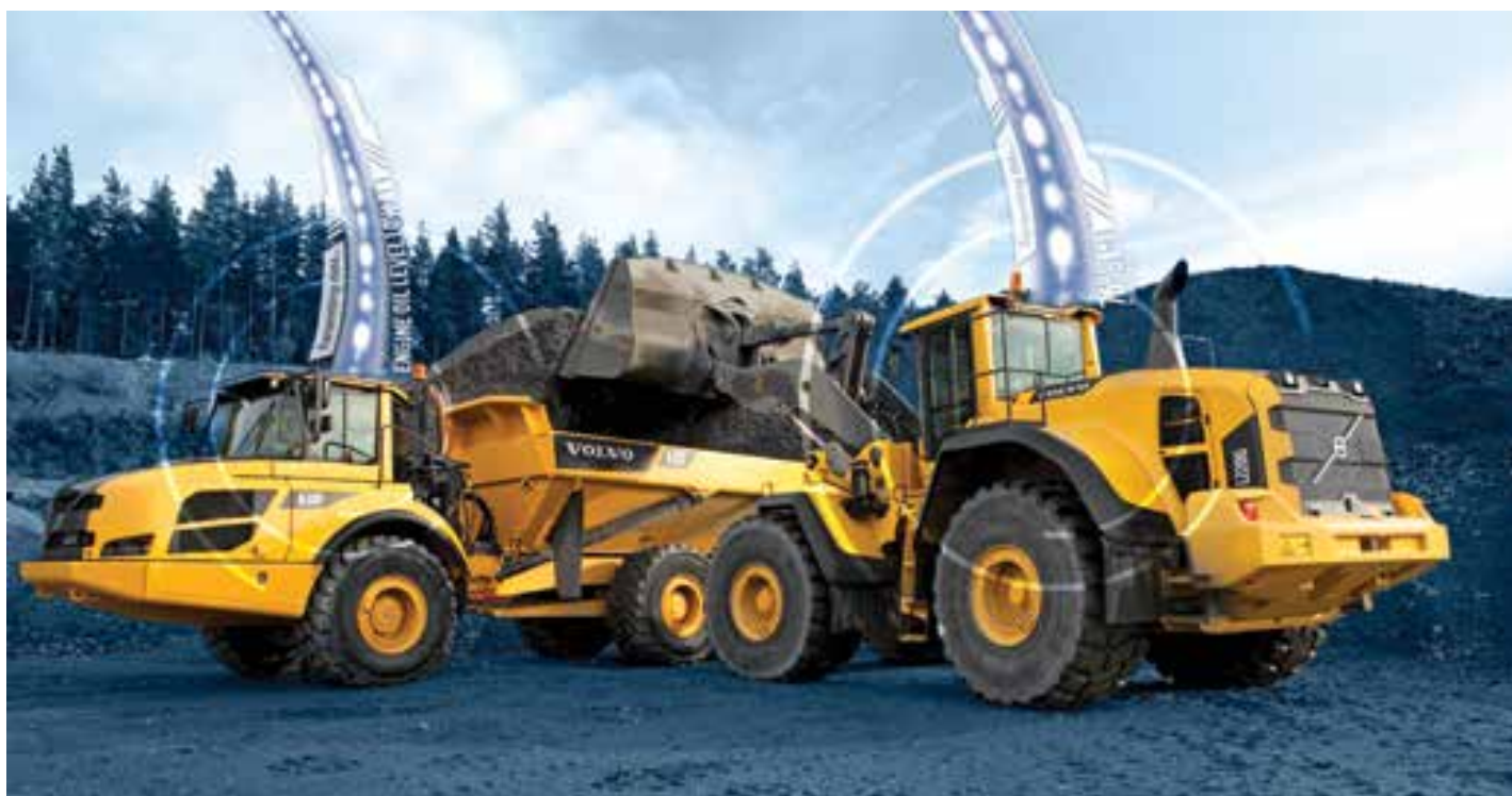
Система CareTrack собирает данные о машине, включая расход топлива и эффективность работы, и предоставляет их владельцу машины и местному дилеру.
