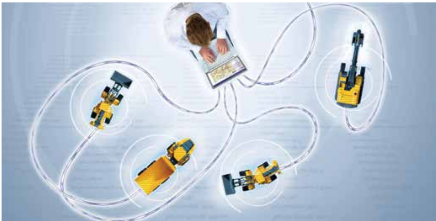
MATRIS en CareTrack werken samen en geven informatie over het brandstofverbruik, de motorprestaties, de planning van de onderhoudsbeurten en storingen.
