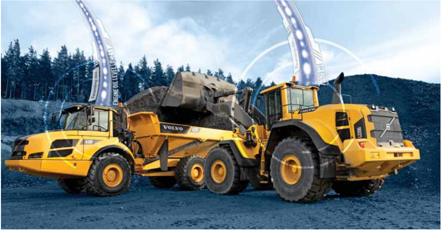
케어트랙 시스템은 연료 소모와 작동 성능을 포함한 장비 데이터를 제공하며, 이 데이터들은 원격으로 장비 소유주와 현지 딜러가 검토할 수 있다.
