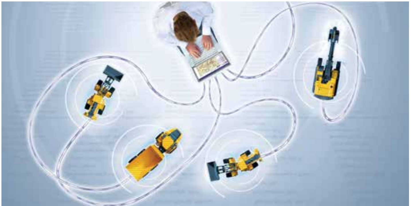
Los sistemas MATRIS y CareTrack ofrecen información sobre consumo de combustible, rendimiento del motor, alertas de mantenimiento e informes de error.
