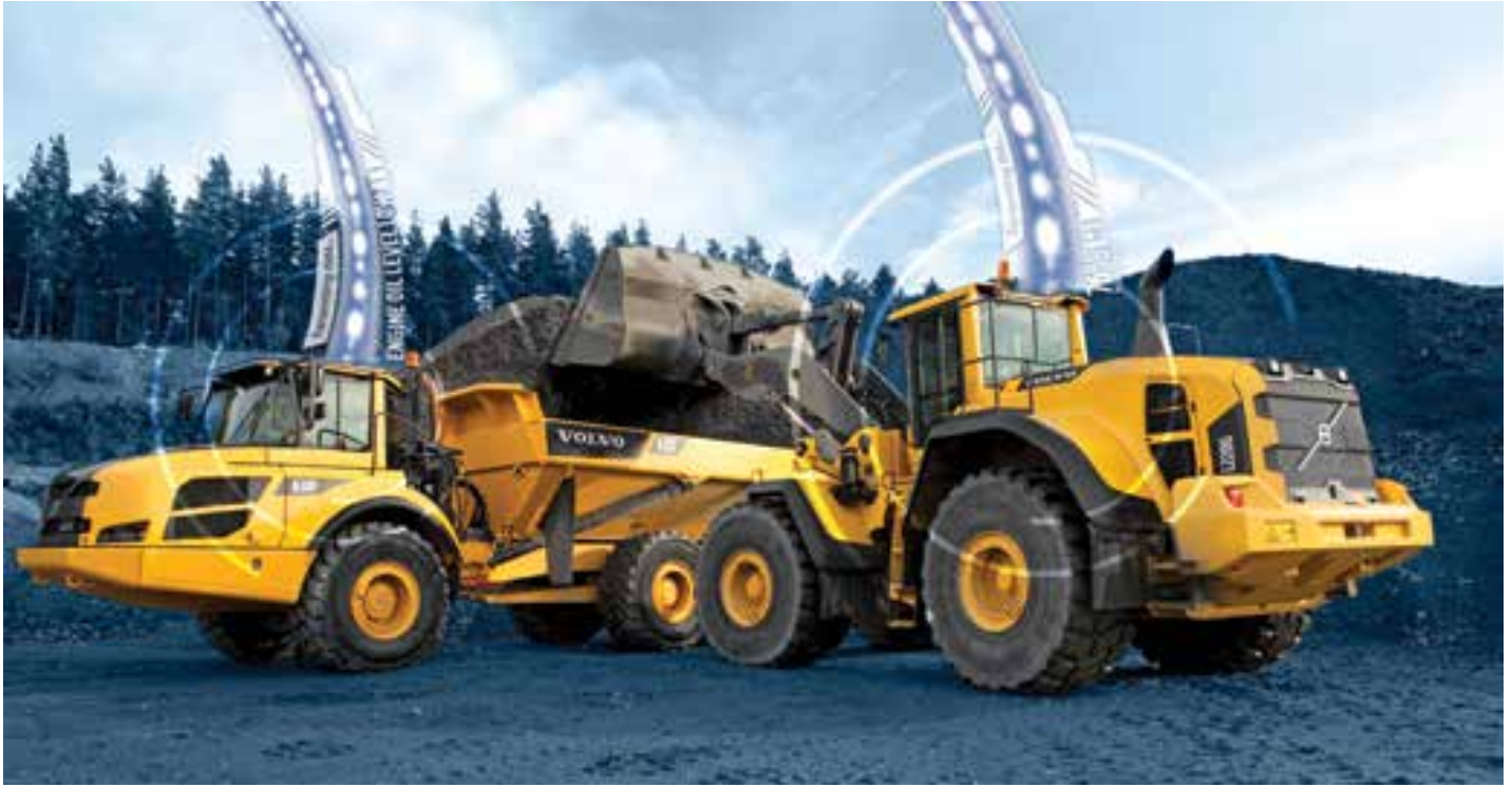
El sistema CareTrack transmite datos de máquinas (como el consumo de combustible o el rendimiento) para que el propietario y el concesionario local los puedan analizar a distancia.
