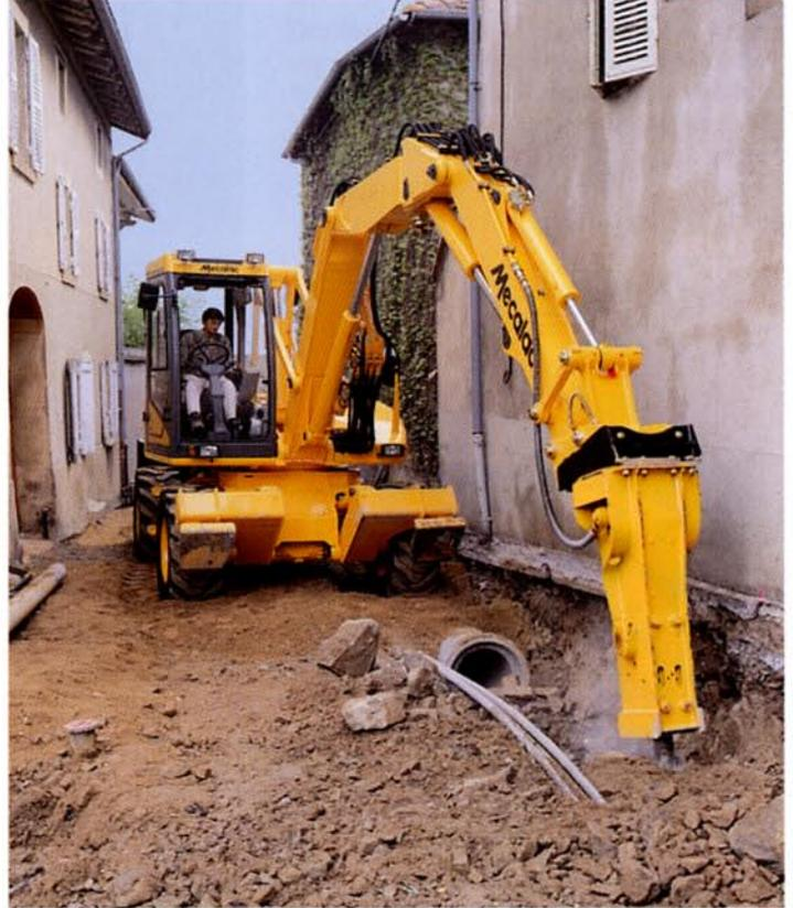
*“8.15 Uhr. Der Mecalac verwandelt sich in einen Geräteträger. Mit Hilfe seines Schnellwechselsystems wird in wenigen Sekunden die Schaufel ab- und der Hydraulikhammer angebaut. Die präzisen und progressiven Bewegungen erlauben den Hammereinsatz in unmittelbarer Nähe bereits vorhandener Einrichtungen. Die leistungsstarke Maschine zerlegt den Granitblock ohne Mühe.”*
