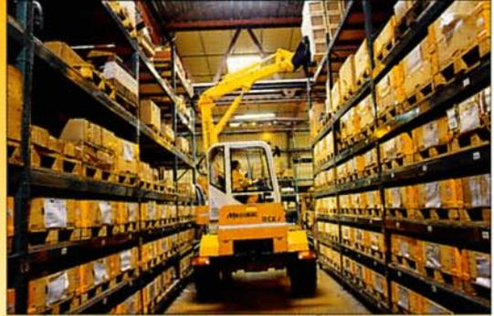
Dank seines 360° Schwenkbereichs arbeitet der MECALAC auch auf engstem Raum.
