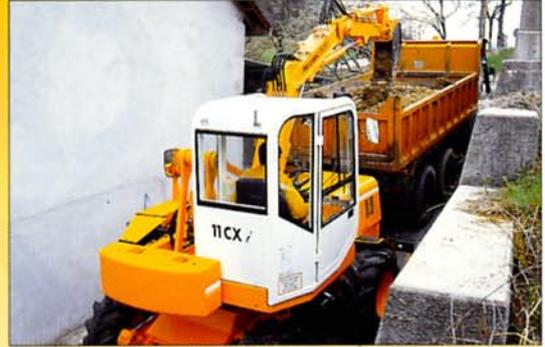
Ermöglicht das Beladen eines LKW über das Heck.
