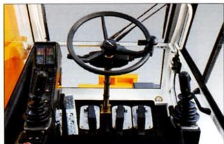
Sehr komfortables Fahrerhaus, schallgedämpft, ausgezeichnete Sicht, ROPS- und FOPS-zugelassen.
