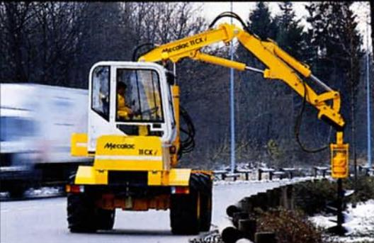
Bohrarbeiten in einem Radius bis zu 6 m und hinter Hindernissen möglich.
