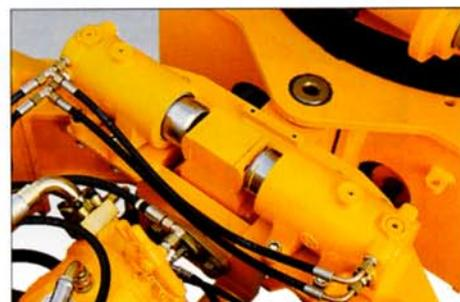
Gelenkblockierung als Standard bei dem Modell 11 CXi und als Option bei dem Modell 11 CX.
