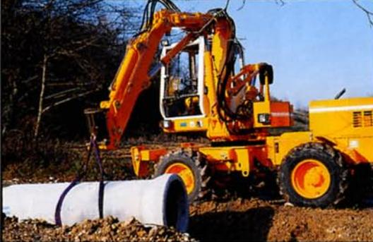
Verlegt seitlich große Rohre in Parallelfahrt zum Graben.
