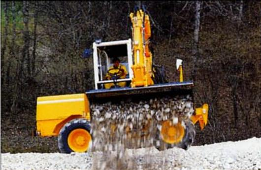
Ermöglicht das Ausheben und Verfüllen eines Grabens in Parallelfahrt.
