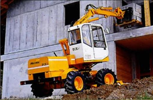
Materialumschlag im Gelände mit einem Schwenkbereich von 360°, von -3,5 m bis + 6 m.
