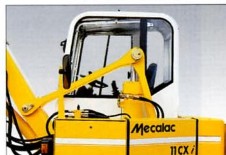
Auslegerzylinder mit Parallelogramm für variable Hubhöhe.
