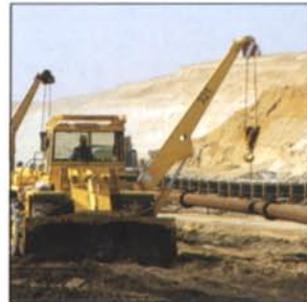
Ein überzeugendes Kosten-Nutzen-Verhältnis bietet der ZD 3001 mit hydraulisch gesteuertem Seitenkran und Planierschild in allen Einsätzen: z. B. Verlegen von Pipelines, Transport von schweren Aggregaten, Kanalisierung und Bewässerung etc.
