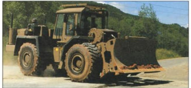
Der ZD 3000 F setzt Maßstäbe in jeder Beziehung: innerhalb Sekunden werden die beiden Seitenteile des Räumschildes eingeklappt und arretiert, so daß der Dozer mit 2,75 m Breite eine selbstfahrende Baumaschine bleibt mit StVZO-Zulassung; ein Pluspunkt für die Mobilität.
