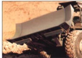
8 Schildbewegungen können vom Fahrersitz aus hydraulisch gesteuert werden – je 2 Bewegungen gleichzeitig. Mit nur einem Steuerhebel schaltet der Fahrer alle Funktionen, nämlich: Heben, Senken, Schnittwinkel, Schwenken, Tilt. Das heißt für die Praxis: supereinfache Bedienung und schnelle Arbeitsspiele.
