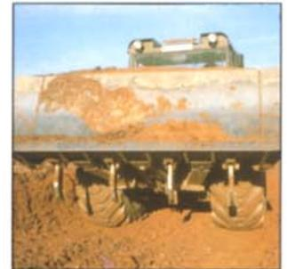
Für harte und gefrorene Böden verfügt das ZM-Planierschild über 4 Aufreibzähne: Aufreibtiefe bis 450 mm (Aufreißen beim Zurückfahren).
