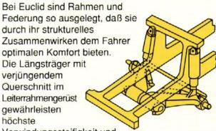
Verwindungssteifigkeit und sparen gleichzeitig unnötiges Gewicht ein. Dank erprobter Konzepte und praktischer Erfahrung im Herstellungsprozess haben Euclids Rahmen eine lange Lebensdauer.
