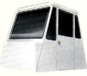
wurde in eine bedeutend fahrerfreundlichere Kabine verwandelt. Schaumgummiplatten zusammen mit Wandbekleidungsstoff auf Schaumgummiunterlage und eine mehrschichtige Bodenmatte wirken schalldämmend und zugleich wärmeisolierend. Eine Anordnung mit Dreipunkt-Gummipuffern auf der Kabinenplattform wirkt ebenfalls isolierend und hält die Kabine weitgehend schwingungs- und erschütterungsfrei.
