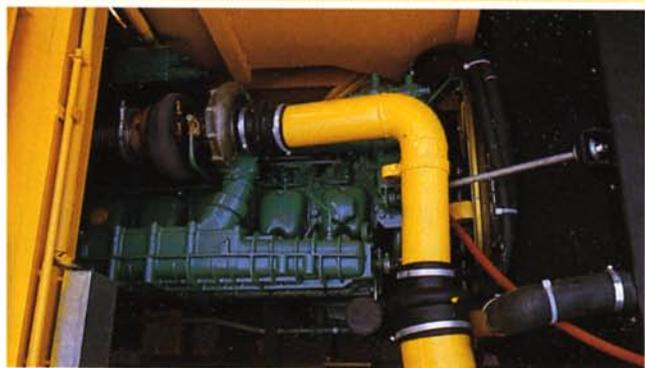
Motor und Getriebe sind leicht zugänglich eingebaut. Dank optimaler Standardisierung ist für Service und Wartung nur wenig Spezialwerkzeug erforderlich. Sichere Bügel und rutschfeste Stufen erleichtern die Durchführung der täglichen Wartung.
