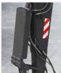
**Le protezioni di benna e cilindro del braccio** preservano perni, cilindri, valvole anticaduta di sicurezza e tubature da oggetti cadenti. Queste lamine in acciaio riducono il rischio di danni alla macchina, oltre a migliorare la disponibilità in tutti i tipi di lavori di demolizione.
