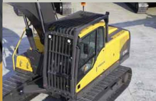
• La struttura FOG protegge l'operatore.
