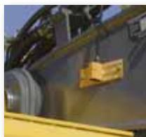
**L'indicatore "Total Moment"** montato sul braccio avvisa quando l'escavatore HR si stia avvicinando al massimo carico di sicurezza.
