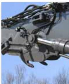
L'innovativo **giunto modulare idraulico** utilizza un meccanismo di **chiusura idraulica** per sganciare le attrezzature da scavo o **passare dal braccio da demolizione ad alto sbraccio** alla configurazione di braccio da scavo standard in **meno di 30 minuti**. La caratteristica migliora notevolmente la versatilità.
