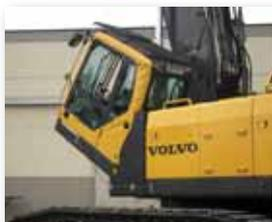
**Cabina inclinabile che si inclina fino a 30 gradi** per una migliore visibilità e minore fatica nei lavori ad alto sbraccio. Standard nei modelli Ultra High Reach (HR) e optional nei modelli di Escavatori da Demolizione Standard.
