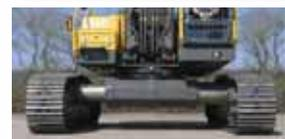
**I guida cingoli integrali tengono lontane** le macerie della demolizione dalle parti sensibili del carro, evitando che tondini o altri oggetti accidentali penetrino o si depositino nei cingoli. Il sottocarro estendibile si allarga di 1 metro per migliorare la stabilità.
