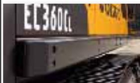
**Le système de protection contre les chocs latéraux** boulonné préserve la tourelle des dommages.
