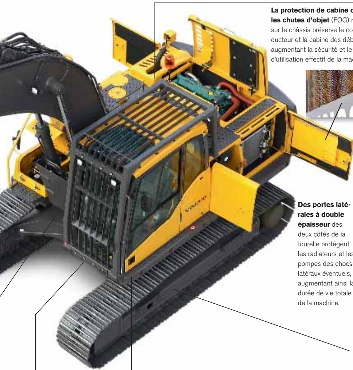
**La protection de cabine contre les chutes d'objet (FOG)** montée sur le châssis préserve le conducteur et la cabine des débris, augmentant la sécurité et le temps d'utilisation effectif de la machine.
