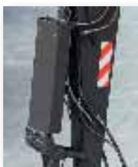
**Dispositifs sur les vérins de godet et de flèche** protégeant les tiges, les vérins, les vannes de rupture de durite et les conduites des chutes d'objet. Ces enveloppes en acier réduisent les risques d'endommagement et améliorent le temps d'utilisation effectif, quel que soit le type de travail de démolition.
