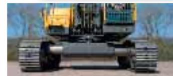
**Les chenilles sont protégées sur toute leur longueur** afin d'empêcher les intrusions de débris et d'éviter que les barres d'armature et autres objets pointus ne se logent dans les chenilles. Le châssis porteur extensible se déploie de 1 m (3' 3") afin d'augmenter la stabilité.
