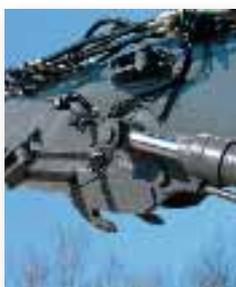
**Assemblage modulaire hydraulique** innovant, doté d'un mécanisme de **verrouillage hydraulique** pour libérer l'équipement d'excavation et **passer d'une flèche de démolition de portée élevée** à une configuration de pelle rétro standard **en moins de 30 minutes**. Cette fonction augmente considérablement la polyvalence de la machine.
