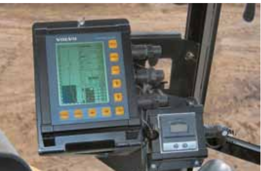
密实度分析仪 沃尔沃的密实度分析仪为工程承包商提供完整，全面的压实过程数据文件，承包商能更经济有效的组织他们的施工工作。
