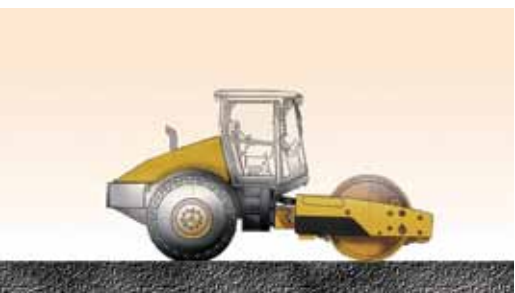
最高的安全性 机器的设计充分考虑了各种安全性因素：“1米远1米高”的工作视线范围。驾驶员的操作平台采用防滑材料制作。 采用弹簧锁定，液压释放的刹车系统，OPS/FOPS和安全带，以及倒车报警装置。
