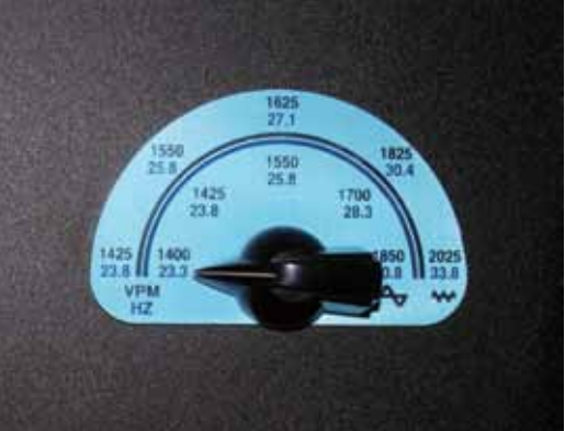
可调频率 有多档频率可选择，驾驶员可以根据所压实的具体材料，选择最适宜的振动频率。在大型的压路机中，可变的激振力能达到1米的压实影响深度。
