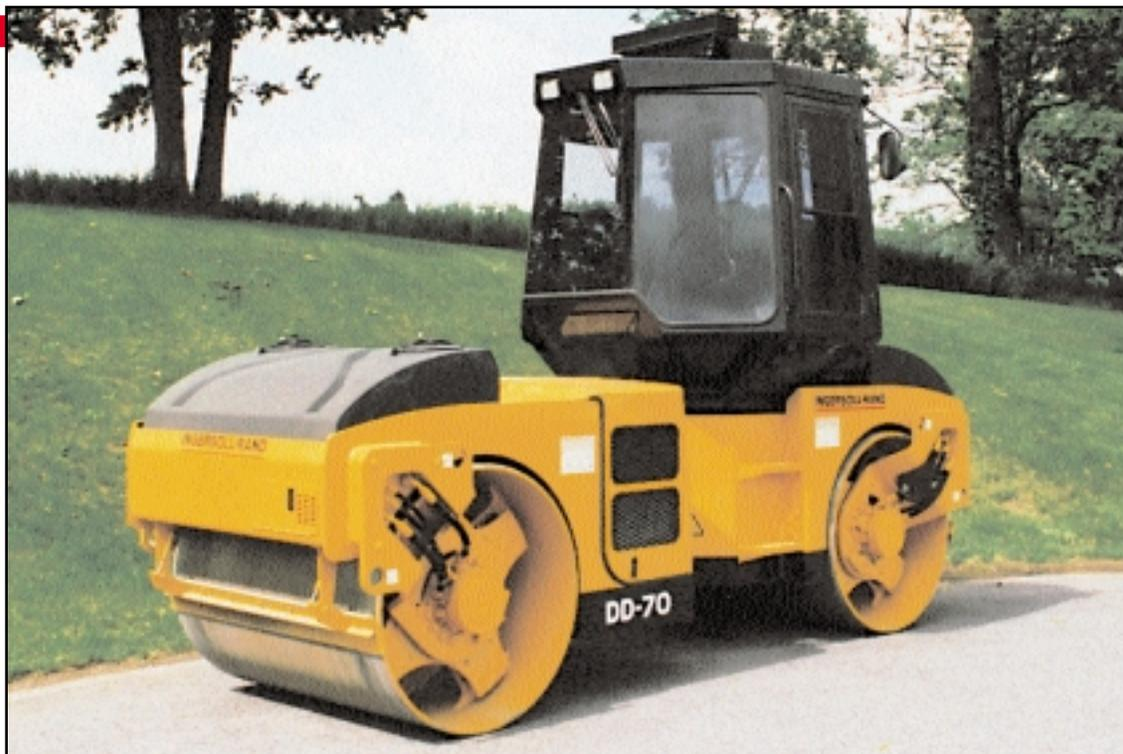
Le DD-70 est équipé de deux cylindres de 1450 mm de largeur lui permettant d'atteindre un rendement de 180 t/h. La fréquence de vibration de 55 Hz autorise une vitesse de travail plus élevée tout en maintenant un état de surface de qualité. Les supports des cylindres montés en diagonale dégagent la visibilité sur les bords des cylindres et la zone à compacter
