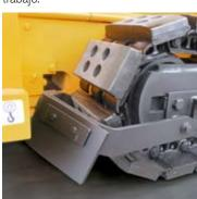
Gran tolva de material con gran capacidad. Las paredes laterales plegables y cintas transportadoras de material dispuestas hacia delante permiten un buen vaciado en todo el entorno de la
