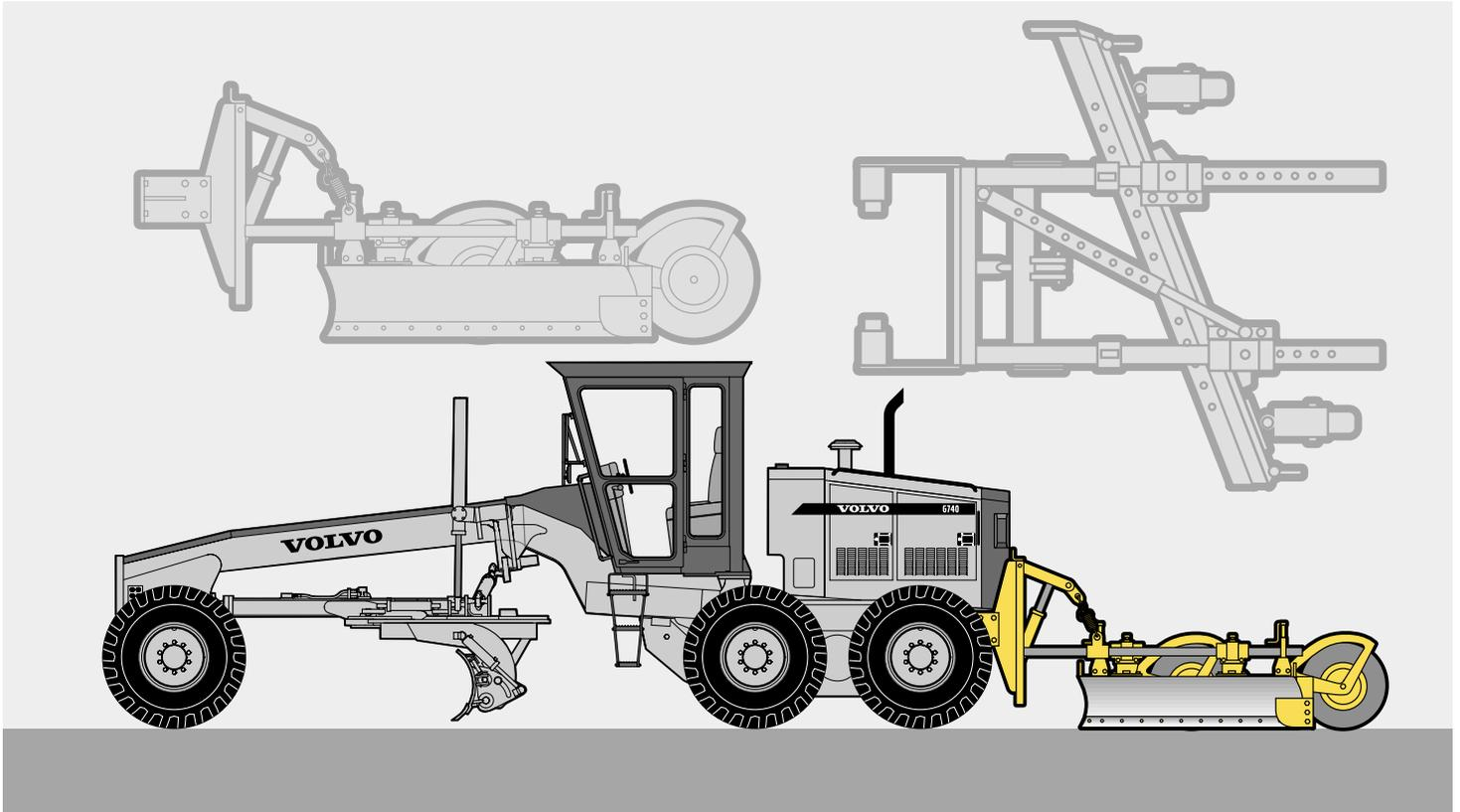
El eliminador de camellones se utiliza para el mantenimiento en una pasada de la superficie de carreteras o de bermas laterales. El eliminador de camellones se monta en la parte trasera de la motoniveladora y redistribuye los camellones desde la vertedera de la motoniveladora, de modo que no hace falta una segunda pasada, por lo que se ahorra tiempo y se aumenta la eficiencia.
