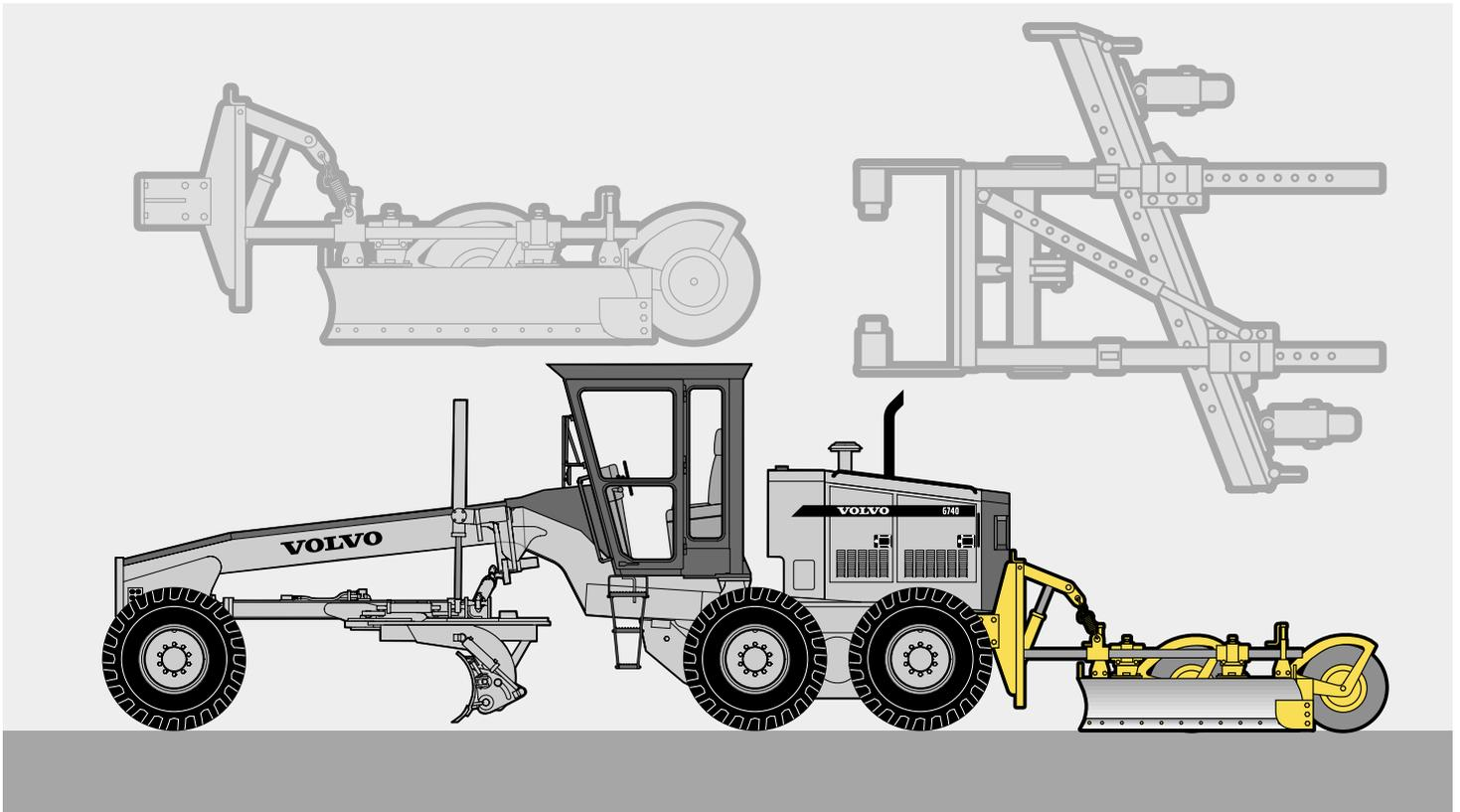
L'éliminateur de crêtes Volvo est utilisé pour l'entretien des routes et des accotements en une passe. Il se monte à l'arrière de la niveleuse et redistribue les crêtes laissées par la lame, éliminant la nécessité d'une seconde passe, ce qui sauve du temps et augmente l'efficacité.
