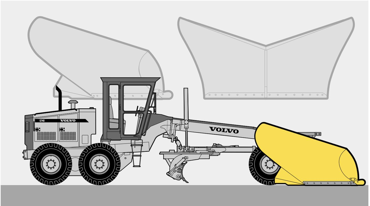
Le chasse-neige Volvo en V est conçu pour les durs travaux de déneigement comme l'ouverture des chemins non déneigés. Le chasse-neige en V tranche les masses de neige et les déplace de chaque côté pour maximiser le dégagement en une seule passe à haute vitesse.
