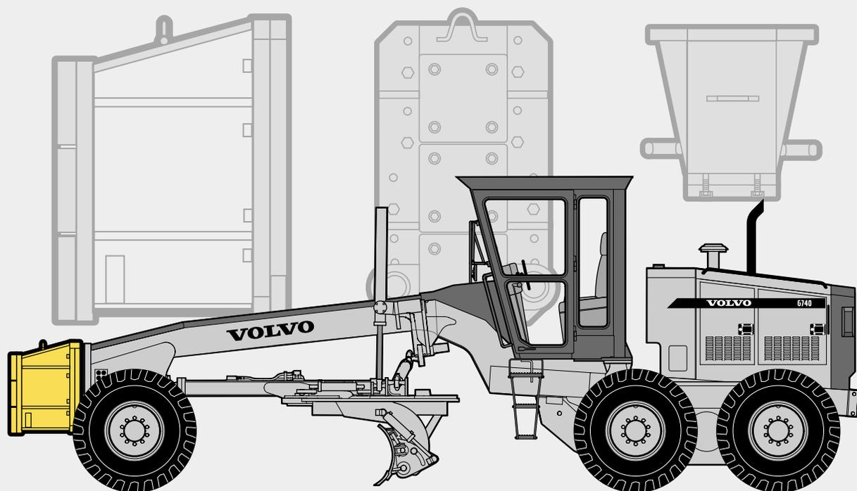
El bloque de empuje Volvo se monta en la placa frontal de la motoniveladora y realiza dos funciones básicas:
