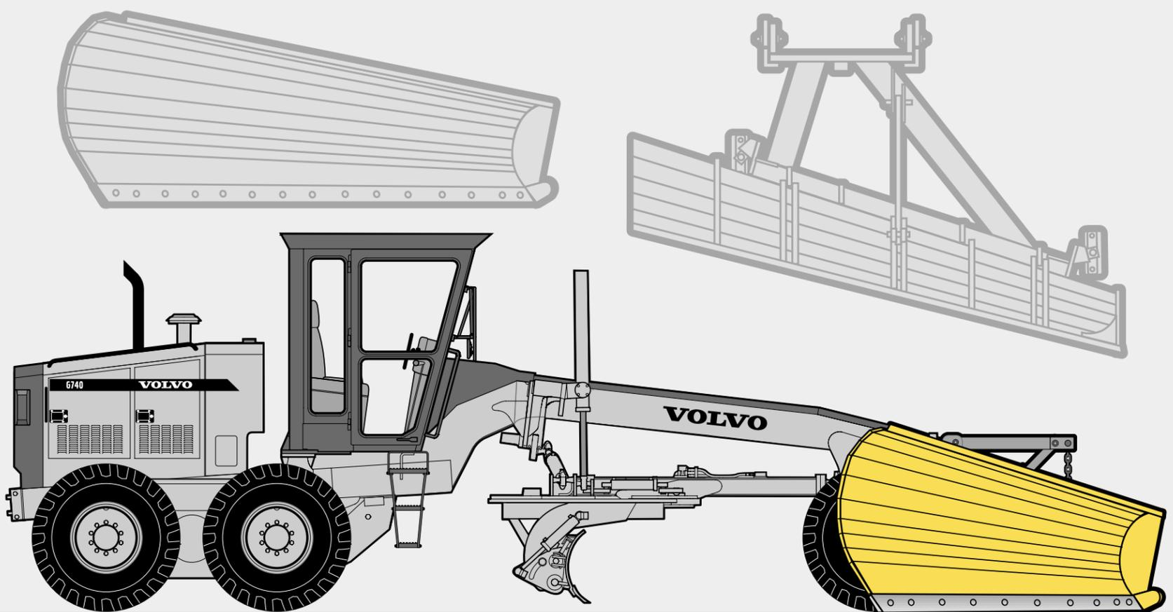
Le chasse-neige Volvo à sens unique est utilisé dans les situations où l'on a besoin de décharger la neige du côté droit seulement. Il est muni d'un contrôle manuel qui permet de régler l'angle d'attaque pour optimiser le déblaiement et l'efficacité de déneigement.
