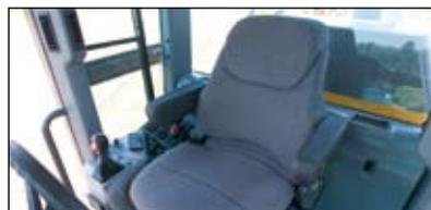
Siège à suspension pneumatique
