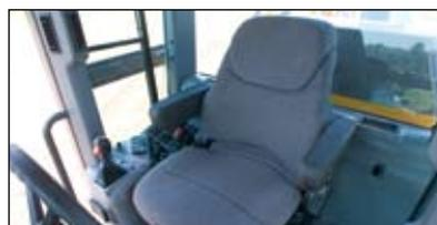
Siège à suspension pneumatique
