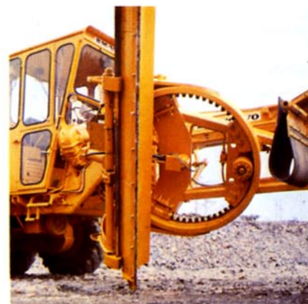
Säkerhetskoppling för hyvelbladets svängfunktion.
