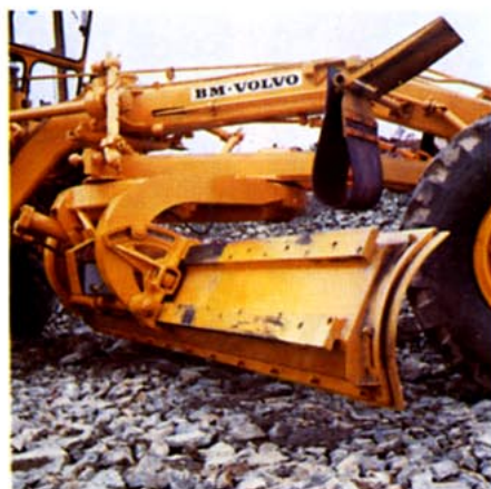
Hydraulisk skärvinkelinställning. Vitala slitdelar utbytbara.
