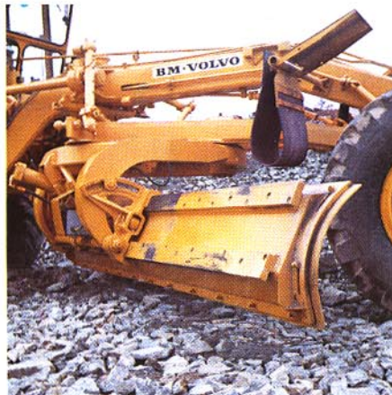
Hydraulisk skärvinkelinställning. Vitala sliddelar utbytbara.
