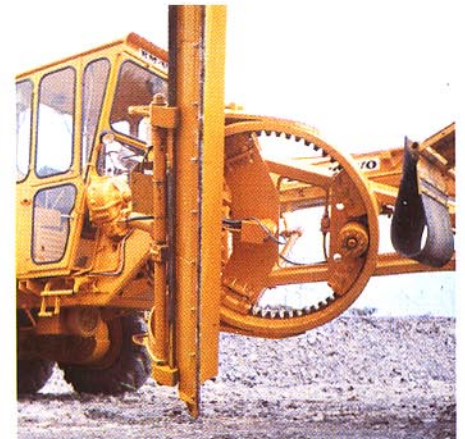
Säkerhetskoppling för hyvelbladets svängfunktion.
