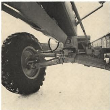
Hydraulisk hjälpstyrning med mekanisk känsl. Den mekaniska styrningen fungerar oberoende av den hydrauliska hjälpstyrningen.
