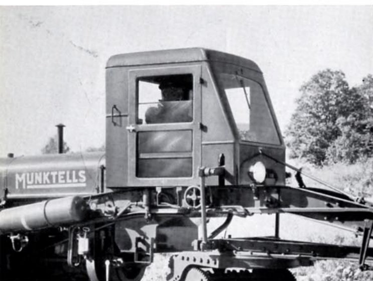
Heltäckt förarehytt med glasdörrar på båda sidorna
