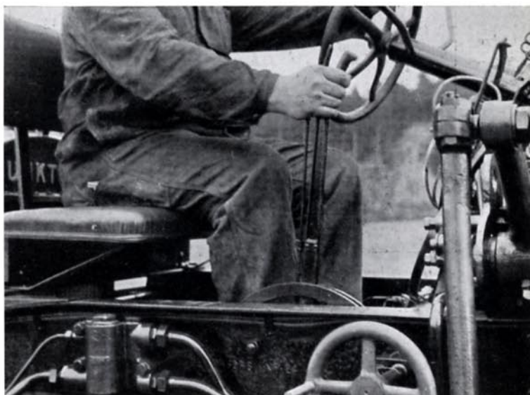
Handbromsspaken har placerats på högra sidan
