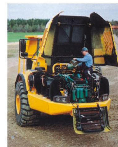
新的发动机罩使您很容易触及到发动机的所有隔间。前部护栅上装有梯子，便于您触及各个维修保养点。
