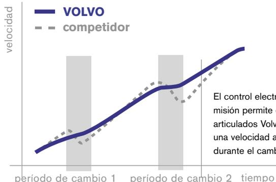
El control electrónico de la transmisión permite que los dúmperes articulados Volvo mantengan una velocidad alta y constante durante el cambio de marcha.
