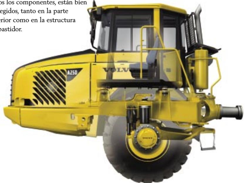
La suspensión de tres puntos de gran seguridad está formada por componentes muy robustos. Una construcción duradera que proporciona una conducción cómoda y suave.
