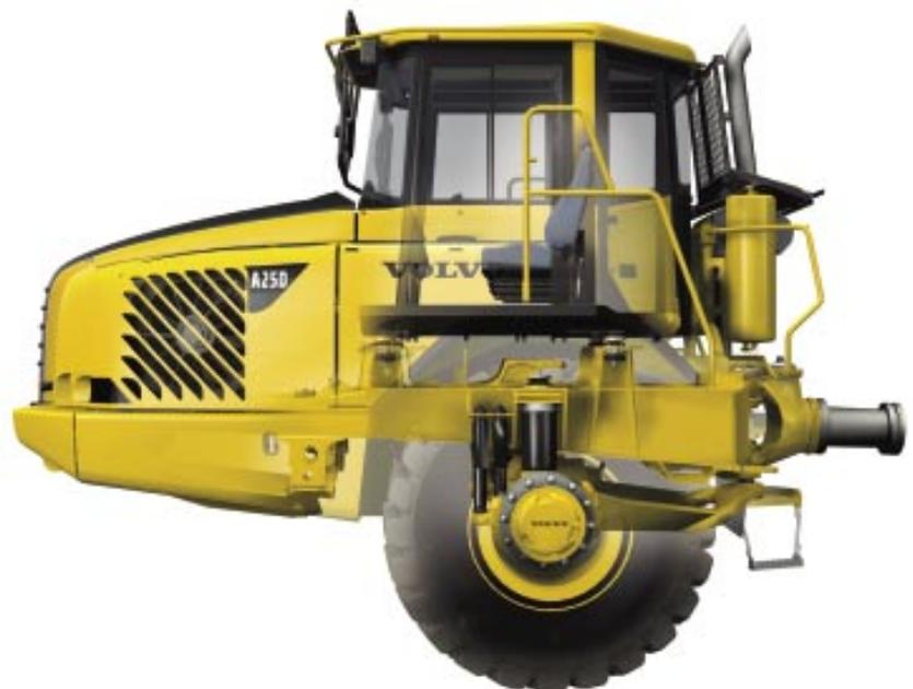
La suspension à trois points est constituée d'éléments robustes." Sa conception durable assure un excellent confort de conduite.
