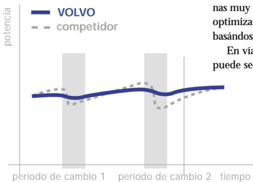
El control electrónico de la transmisión permite que los dúmperes articulados Volvo mantengan una velocidad alta y constante durante el cambio de marcha.
