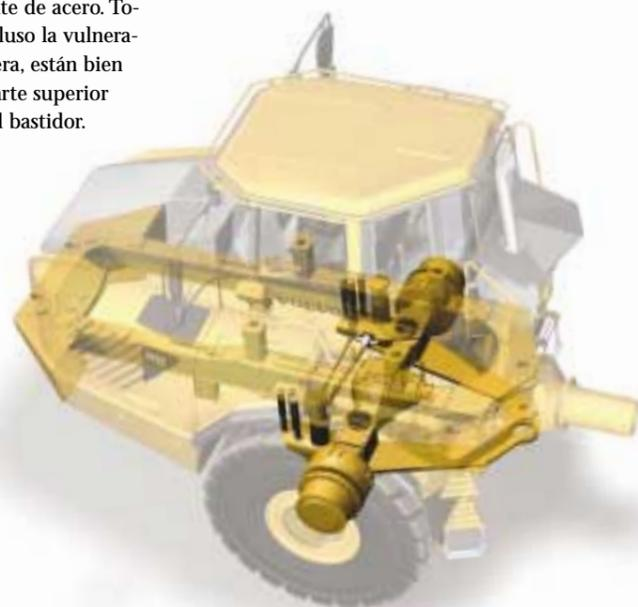
La suspensión de tres puntos de gran seguridad está formada por componentes muy robustos. Una construcción simple y duradera que proporciona una conducción cómoda y suave.
