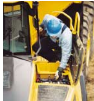
Las baterías, situadas junto al compartimento de almacenaje, son fácilmente accesibles.
