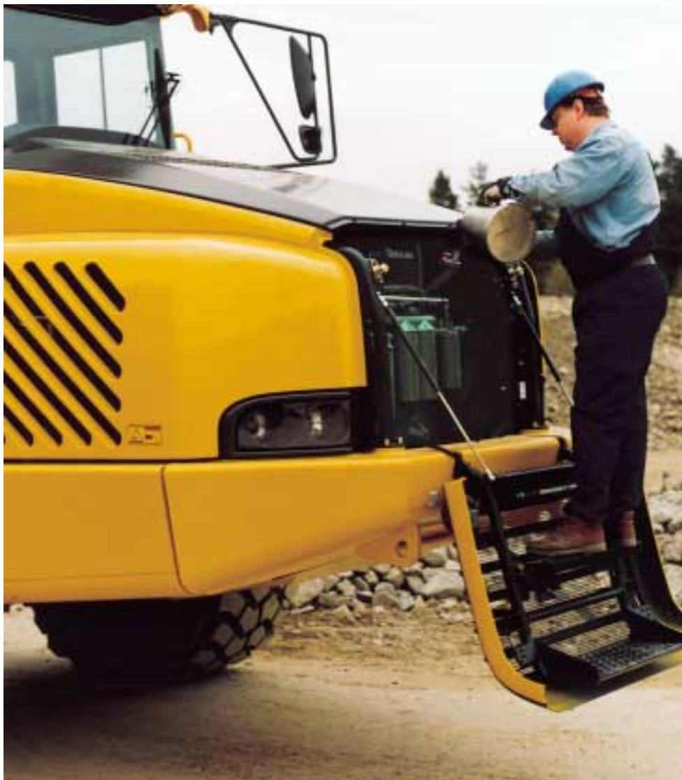
Las baterías, situadas junto al compartimento de almacenaje, son fácilmente accesibles.
