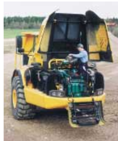
El acceso al compartimento del motor completo es sumamente fácil gracias al nuevo capó. Una escalera de acceso incorporada en la parrilla frontal facilita mucho el acceso a los diferentes puntos de servicio.
