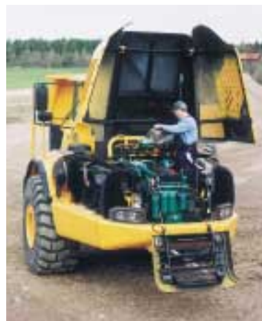
Den nya motorhuvens gör att hela motorutrymmet är mycket lätt åtkomligt. I framgrillen är en steg integrerad vilket gör att det är mycket lätt att nå olika servicepunkter.
