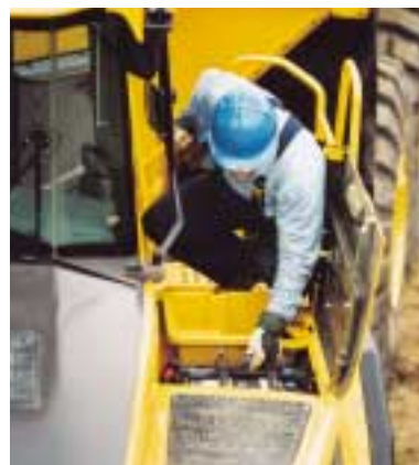
Batterierna är lätt åtkomliga och finns intill lastutrymmet.
