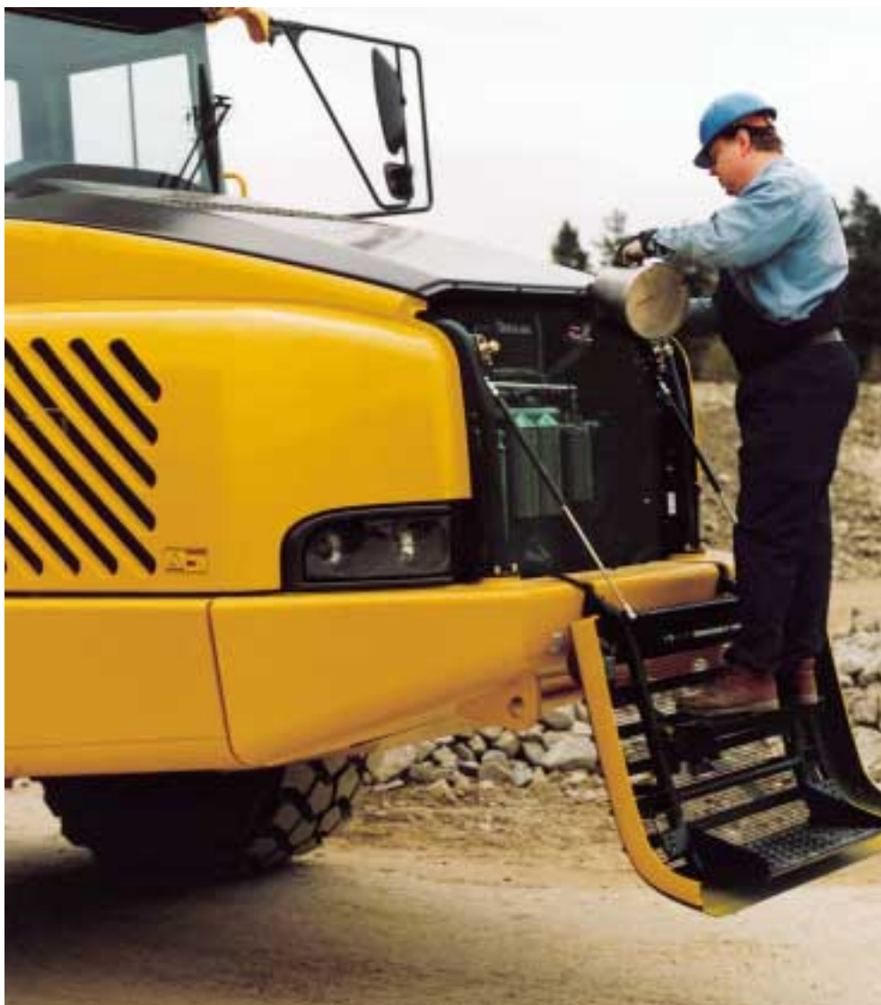
Batterierna är lätt åtkomliga och finns intill lastutrymmet.
