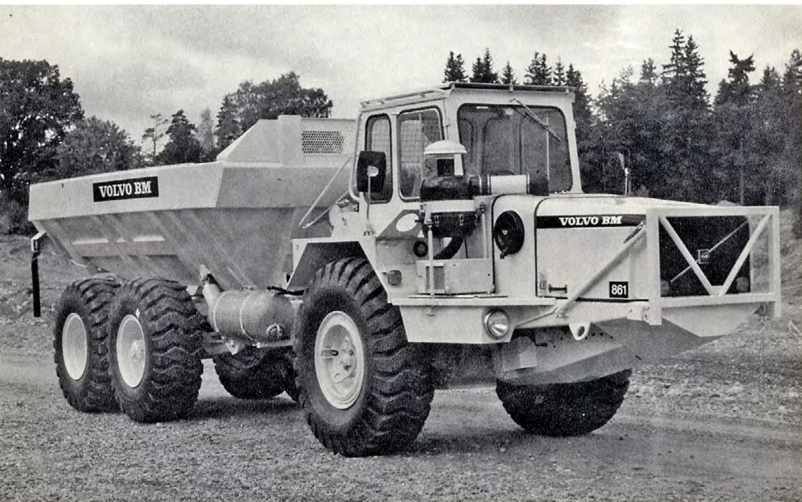
El ventilador de cabina y el filtro de aire en baño de aceite son equipos extra.
